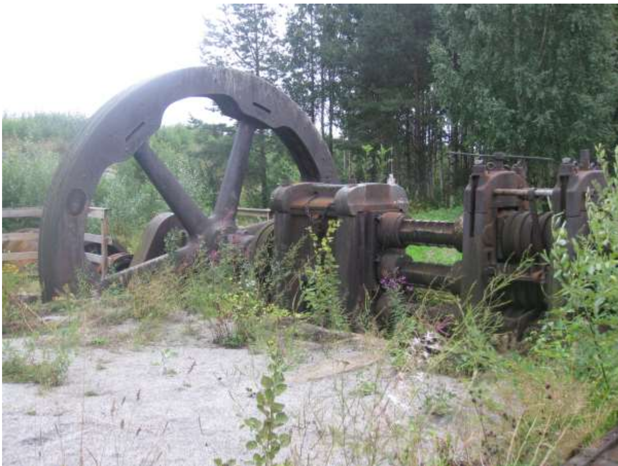
Bild 6: Svänghjul och frammatningsbord efter valsverket. Foto: M Vallström.
